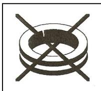
Die Textil-Gewebeeinlage des SEMPERIT-Einlageringes darf keinesfalls beschädigt sein. Ein beschädigter Einlagering oder ein Einlagering mit beschädigter Textil-Gewebeeinlage darf nicht verwendet werden.
